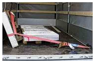
Tonnenschwere Ladung: Diese Alu-Platten auf einem Lkw waren mit nur einem Gurt schlecht gesichert, eine war schon gekippt. FOTO: POLIZEI
